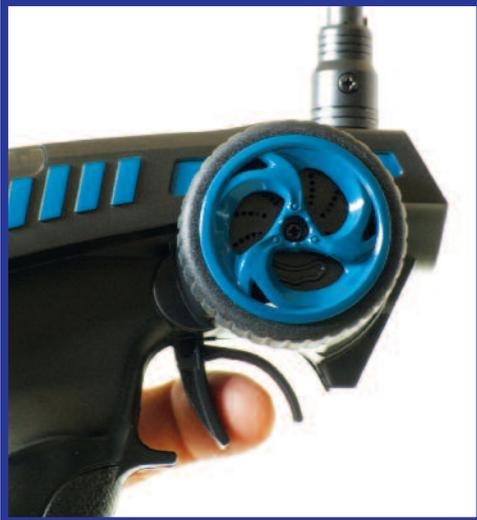
En position milieu le véhicule doit rester stationnaire, si ce n'est pas le cas ajuster le neutre des gaz en conséquence.
