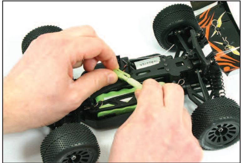
Pour installer une batterie chargée, retirer les clips et enlever la coque. Retirer les pinces qui retiennent la batterie, insérez la batterie et réinstallez les pinces avec le côté plat vers la batterie, puis repositionner la coque et ses clips. Lors de la connexion de la batterie et de l'allumage de la voiture, assurez-vous que la voiture est sur le sol, avec les roues loin d'éventuels objets.
